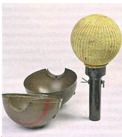
Граната ST или Anti-Tank №74 в раскрытом виде
